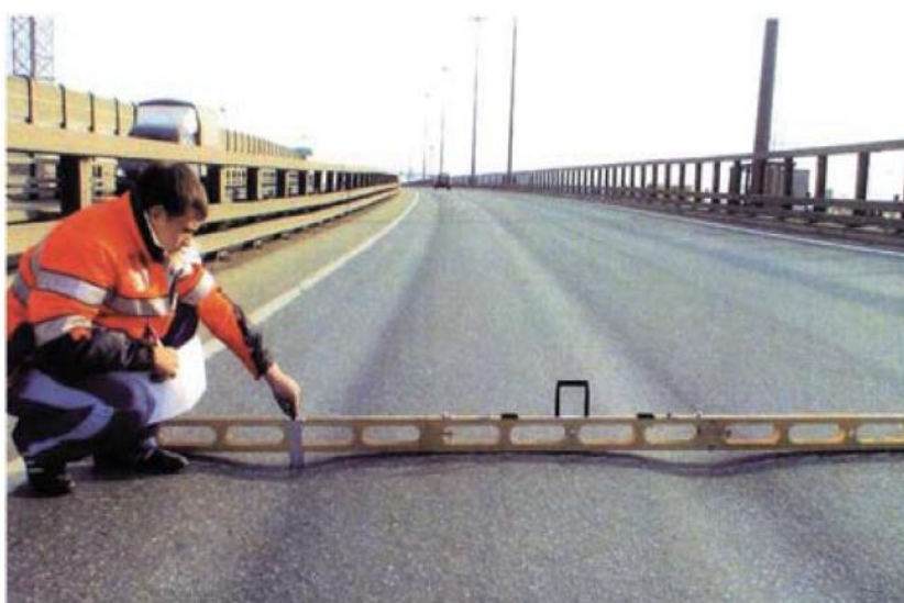
Рис. 1. Исследование колеености асфальтобетонного покрытия на КАД СПб
