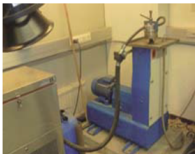
Рис.2. Общий вид установки PRALL с подключенным к ней холодильником для охлаждения воды (используется вода с температурой +5 °С).
